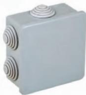
Scatole stagne con passacavi IP44 in materiale plastico isolante autoestinguente, fondo con guide predisposte per il montaggio di morsettiere, temperatura di utilizzo da -5°C a +60°C.
