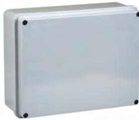
Scatole stagne a pareti lisce IP56 in materiale plastico isolante autoestinguente, fondo con guide predisposte per il montaggio di morsettiere, temperatura di utilizzo da -5°C a +60°C.
