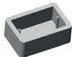
La scatola SCAE permette di realizzare impianti a vista con canaline. Può ospitare fino a 4 frutti, e può essere collegata a canaline di diverse misure poiché pretranciata sulle pareti. Si utilizza per creare punti luce o scatola di derivazione.
